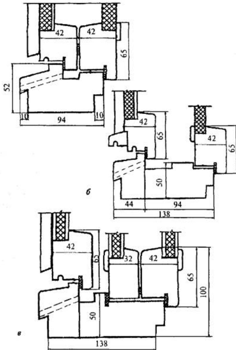
*a* - заполнение наружного полотна - обшивка, рубероид, мягкая и твердая плиты ДВП, заполнение внутреннего полотна - шлифованная плита ДСП; *б* - заполнение наружного полотна - аналогично *a*, заполнение внутреннего полотна - твердые и мягкие плиты ДВП; *в* - заполнение наружного полотна - водостойкая фанера толщиной 8 мм, заполнение других полотен - трехслойная сэндвич-панель с пеноутеплителем
