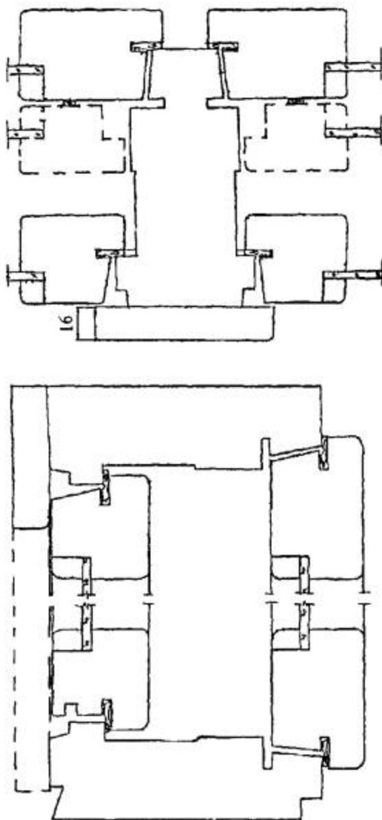
**Рисунок 7** - Пример раздельной конструкции оконного блока с двойным остеклением (брюски коробки имеют универсальный профиль, что позволяет устанавливать дополнительную створку и преобразовывать конструкцию в раздельно-спаренную)
