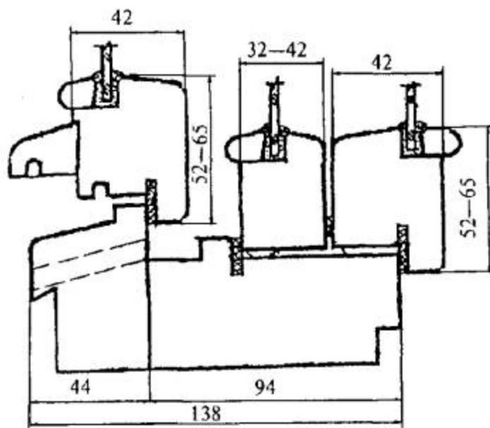
**Рисунок 5** - Примеры конструктивных решений оконных блоков
