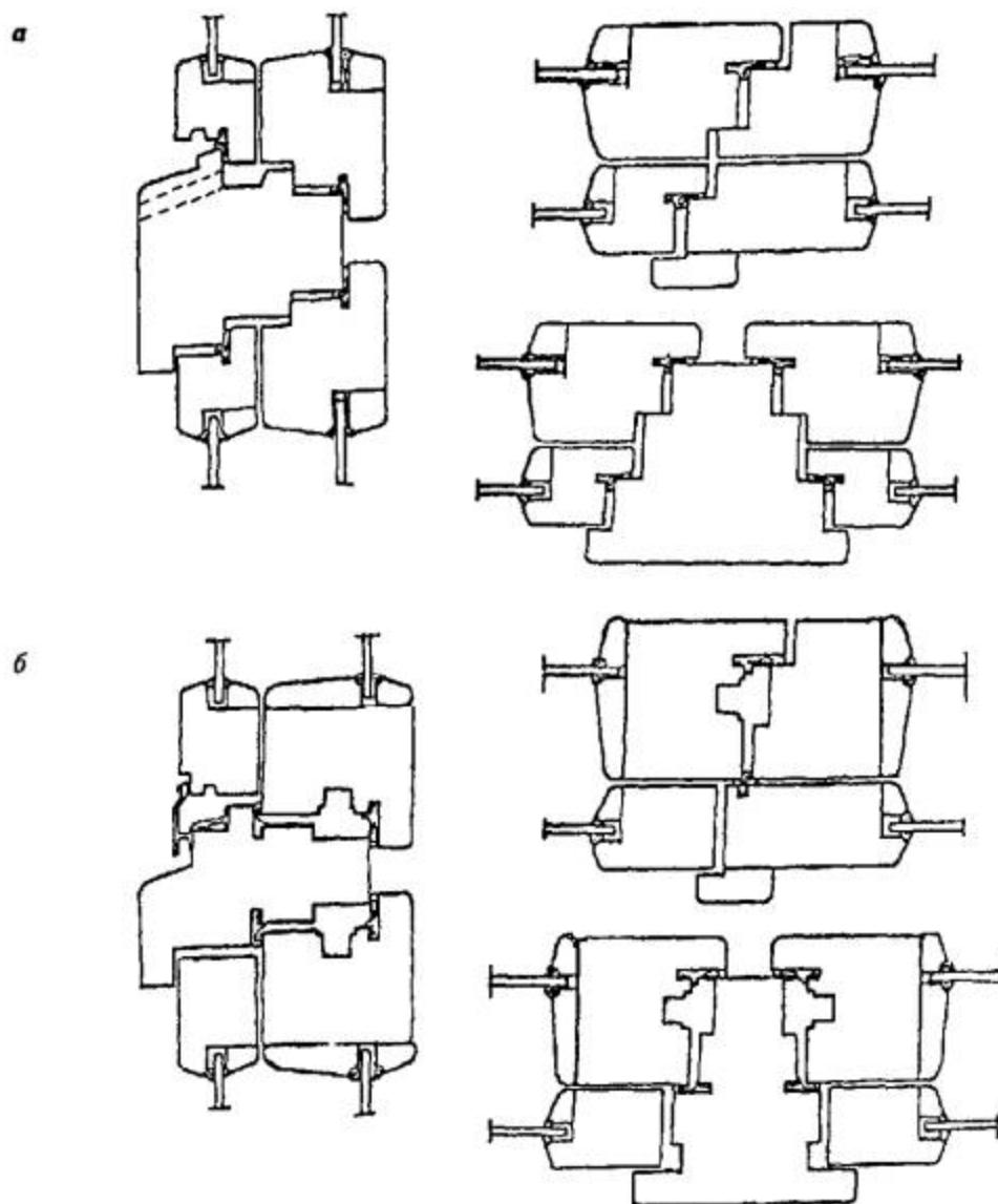
*a* - вариант конструкции с распашным открыванием створок, с двумя контурами прокладок в наружной и внутренней створках; *б* - вариант конструкции с поворотно-откидным открыванием створок, с двумя контурами прокладок во внутренней створке и коробке, с алюминиевым дождезащитным профилем
