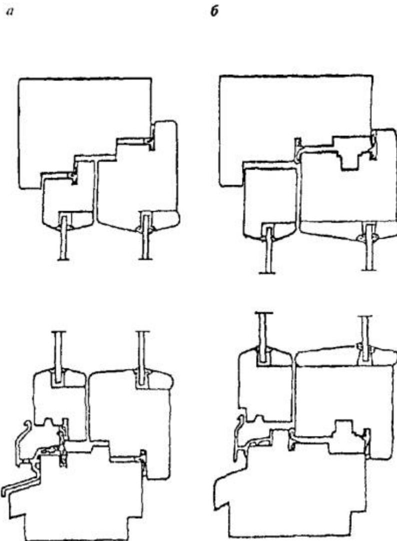
*a* - вариант конструкции с распашным открыванием створок, с двумя контурами прокладок в наружной и внутренней створках, с алюминиевым дождезащитным профилем с термовставкой; *б* - вариант конструкции с поворотно-откидным открыванием створок, с двумя контурами прокладок во внутренней створке и коробке с алюминиевым дождезащитным профилем
