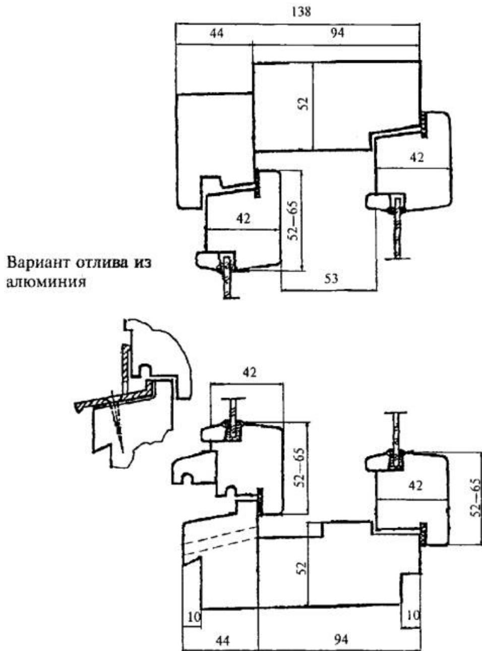
Примечание - Наружный оконный полублок (коробка с навешенными створками) может быть использован как самостоятельное изделие одинарной конструкции.
